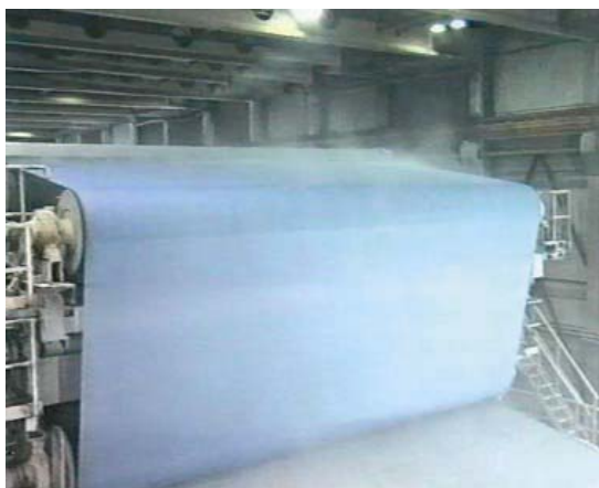
Illustration 1. Brouillard provenant du rinceur HP et qui peut être facilement vu sur la machine à papier.
